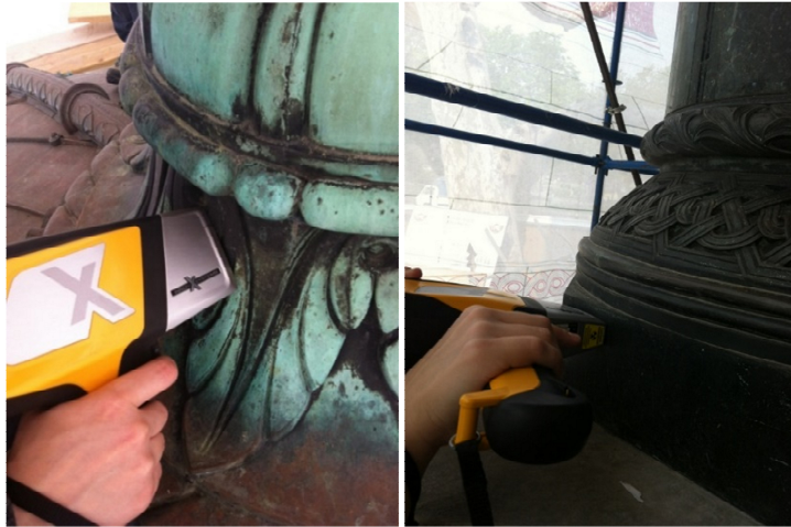
Fig. 14 Alman Çeşmesi'nde bulunan metal yüzeylerin XRF Analizi çalışmaları ,sol foto. (S.Tulgar).
