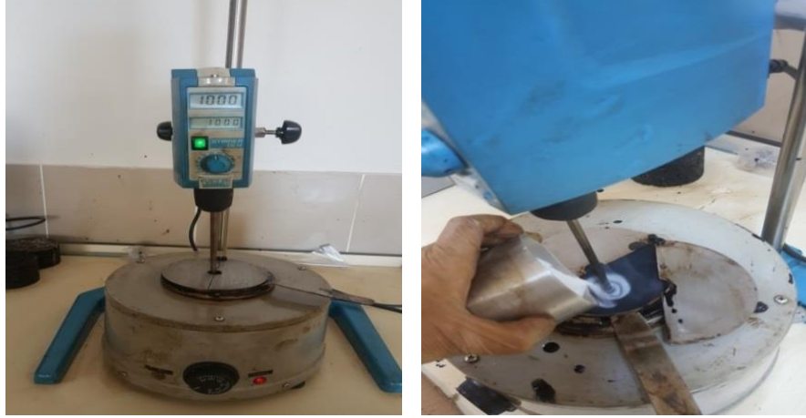
Şekil 1. Karıştırma cihazı (a) ve bitüme PET eklenmesi (b)
