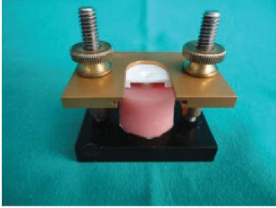
Şekil 1. Akriklik Bloğun bağlantı aparatına yerleştirilmiş hali.
