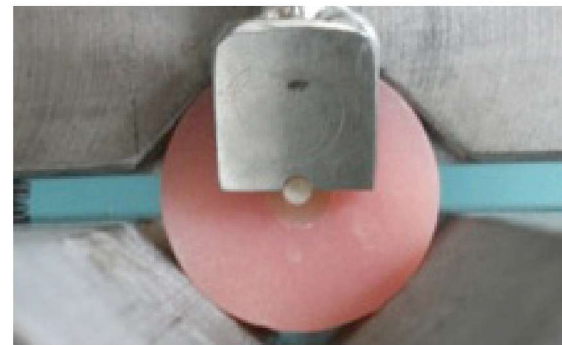
Şekil 2. Deney örneği test cihazına bağlanmış ve kuvvet uygulayacak uç ikinci tabaka kompoziti kavramış durumda.
