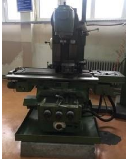
Şekil 3. Üniversal freze tezgahı.
