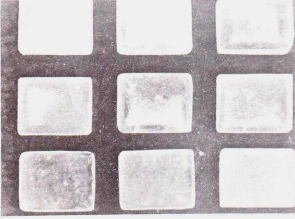
Resim 5- Mikrodalga fırınında farklı yöntemlerle polimerize edilmiş olan Rodex marka şeffaf akrilik reçine örnekleri
