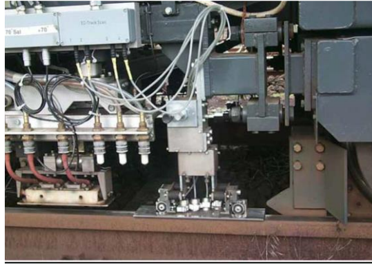
Şekil 8. Girdap akımı prob tutucu ve yüksek hızlı hatların muayenesi için kılavuz (Fotoğraf: R. Krull-Deutsche Bahn AG)
