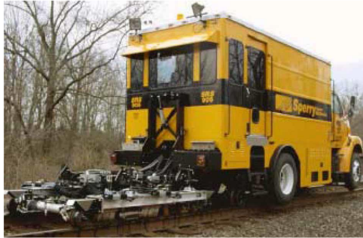
Şekil 10. Hi-rail ultrasonik-MFL kontrol aracı [17]
