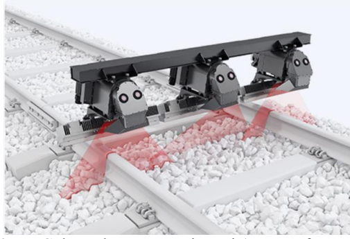
Şekil 2. V-Cube yol muayene sistemi (Fotoğraf: MERMEC)
