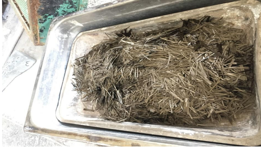
Şekil 4. Bazalt lifi (24 mm kırılmış)
