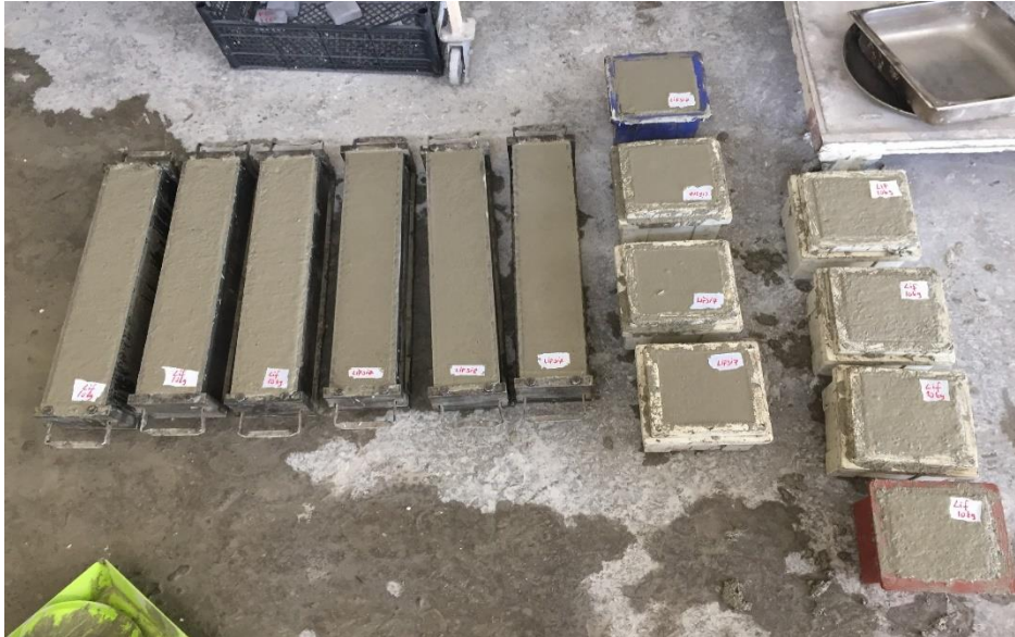
Şekil 6. Küp ve çentikli kiriş numuneler
