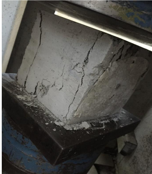
Şekil 8: Tek eksenli basınç dayanımı
