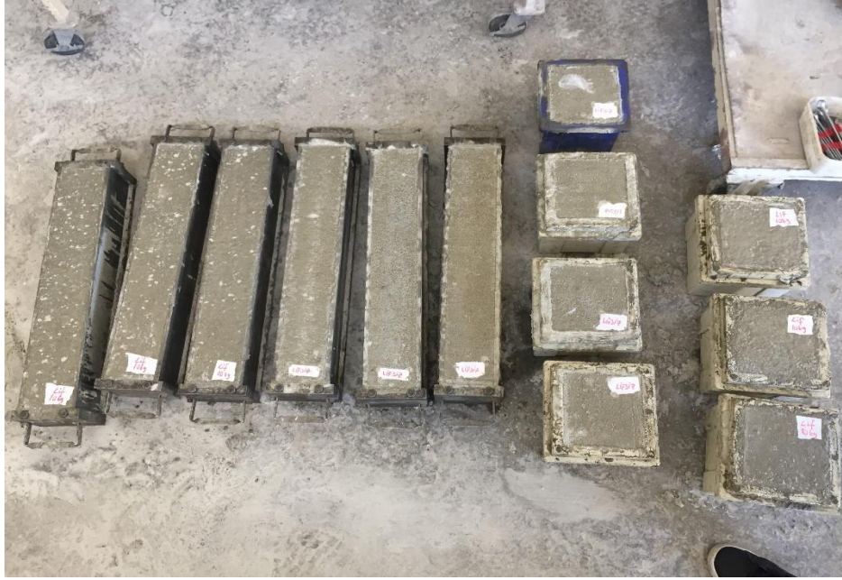
Şekil 7. Kurumuş çentikli kiriş ve küp numuneler
