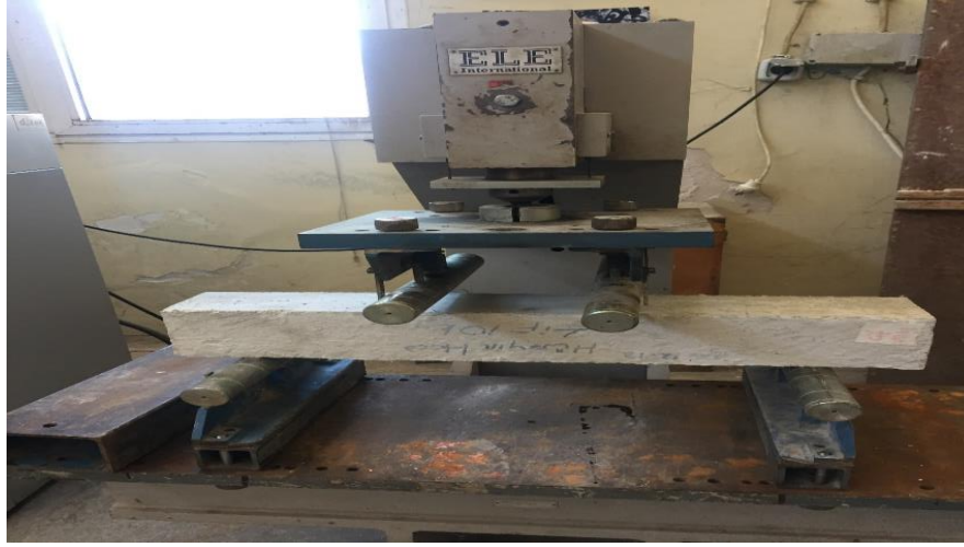
Şekil 9. Eğilme Çekme Dayanımı
