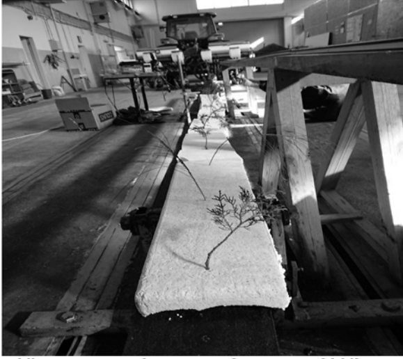
Şekil 5. Denemeler sırasında yapay bitkiler ve yapışkan bantın çalışma şekli
