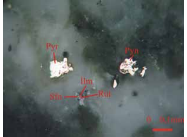
Şekil 21. Pirit (Pyr) ve pirotin (Pyn) ile birlikte ilmenit (İlm) relikti (çevresinde rutil (Rut) ve onun çevresinde de sfen (Sfn) ).
