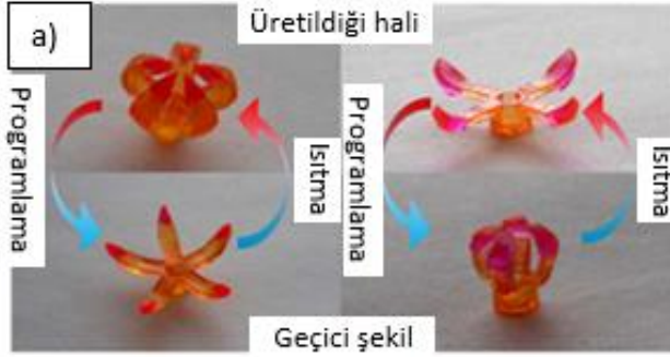
Şekil 10. a) Üretildiği halden geçici şekle, şekil değişim karakterizasyonu, b) Cıvayı kaldırmak için kademeli olarak etkinleştirilen akıllı tutucu [59]
