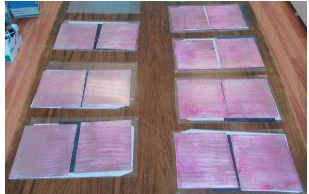
Şekil 2. Primer uygulanmış alüminyum levha yüzeyleri.
