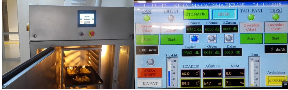
Şekil 1. Elektrikli sıcak hava fırını ve kontrol ekranı
