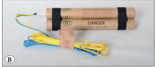
Şekil 5: A,B) Jelatin dinamit.
