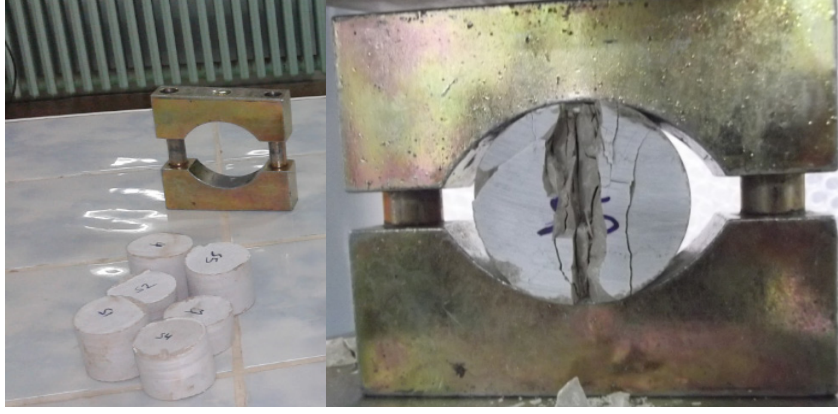
Şekil 4. a) Dolaylı çekme dayanımı (Brazilian) deneyinde kullanılan numuneler ve standart çene, b) Deney sonrasında numunenin görünümü
