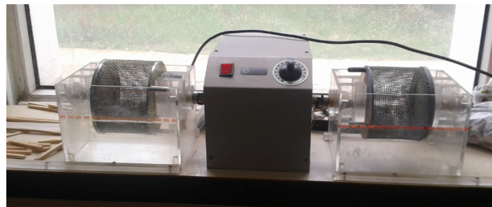
Şekil 7. Suda dağılmaya karşı duraylılık deney düzeneği
