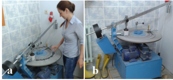
Şekil 6. a) Döner yüzey üzerine aşındırıcı toz dökülmesi, b) Dönmekte olan diske temas halindeki numunenin aşındırılması
