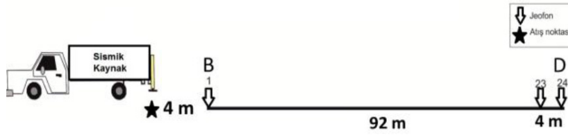
Şekil 8. Arazide uygulanan MASW ölçüm düzeneği.
