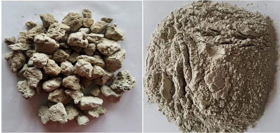
Şekil 1. P-RPB beton üretiminde kullanılan pomzanın pudra haline getirilmiş görünümü
