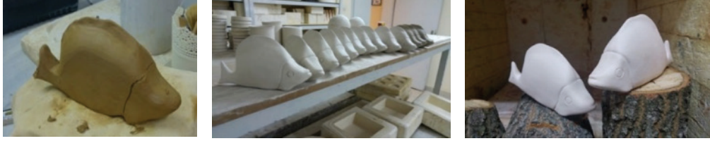
Görsel 9. Obvara Pişirimlerinde Kullanılan Formun Üretim Aşamaları
