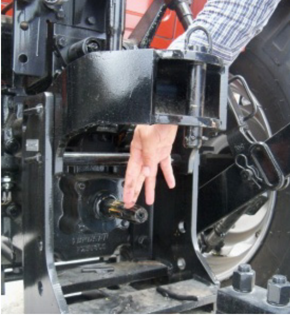
Şekil 10. Traktör 8, Kuyruk miline istem dışı temas riski bulunmaktadır
