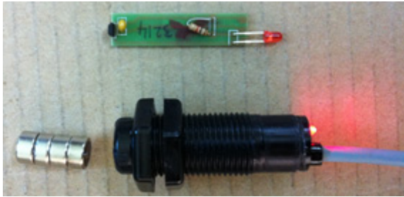
Şekil 1. Çalışmada kullanılan manyetik sensör ve mıknatıs
