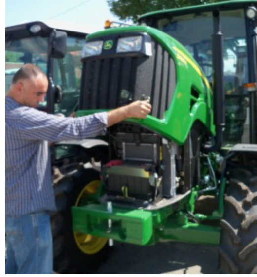
Şekil 12. Traktör 2, Riskli alana uygun olmayan erişim
