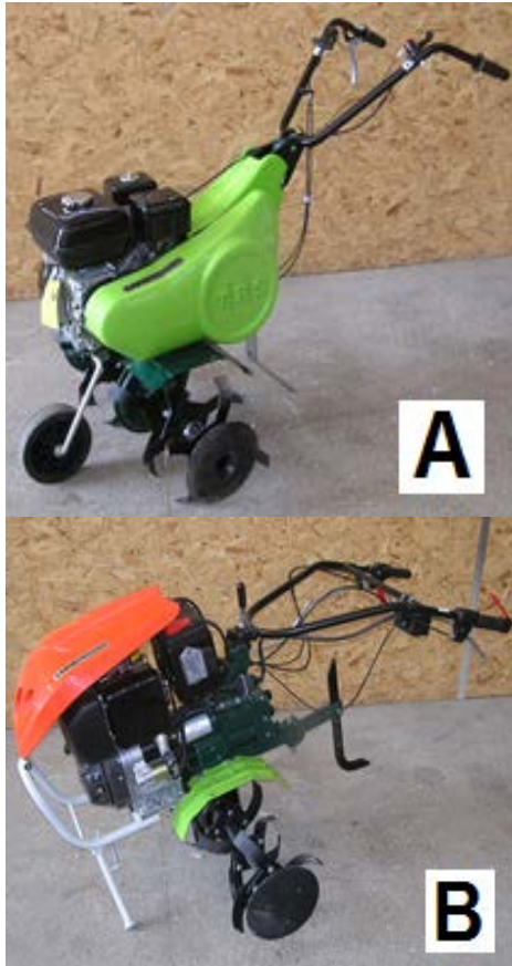
Şekil 1. Denemelerde kullanılan motorlu çapalar (A- Otto motorlu, B- Dizel motorlu)
