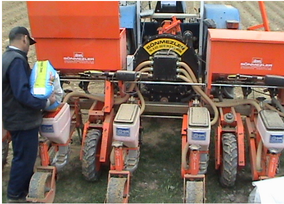
Şekil 2. Harita tabanlı uygulama ile kullanılan ve adapte edilmiş gübre depolu makina (Adana, 2007)
