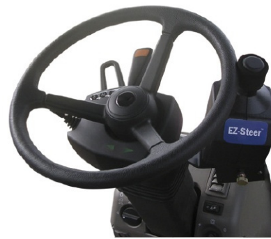
Şekil 3. Aktüatörlü EZ dümenleme (Trimble, 2005)
