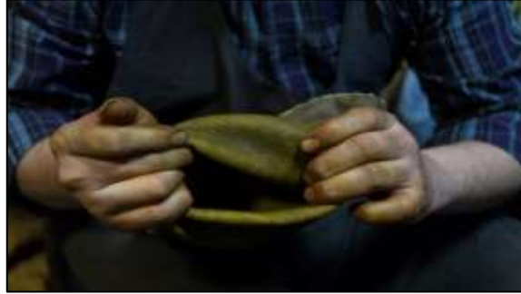
Resim 34: Tabanı dikilen ediğin tersinin içten dışa çevrilmesi.
