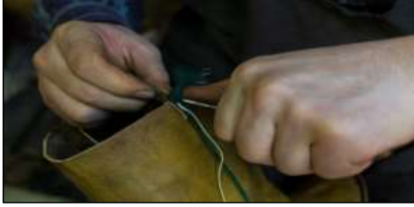
Resim 45: Edik'in boğazına süs kıyılığının dikimi işlemi.
