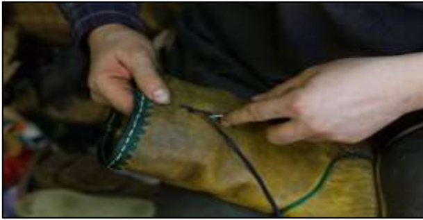
Resim 47: Edik'e işlenecek motif için şeritlerin kesilerek motifin belirlenmesi aşaması.
