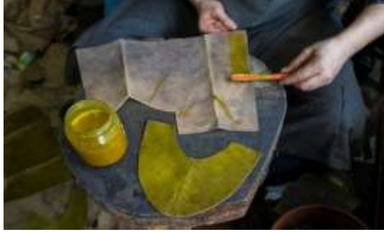
Resim 15: Yüz ve Konç'un boyanma aşaması
