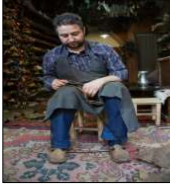
Resim 18: Dikiş işlemine başlamadan önce parçaların kaymaması için, dana derisinden yapılan 'pazvant' olarak isimlendirilen bir kayış ile iki ayak ve bir diz yardımıyla deri sabitlenir.
