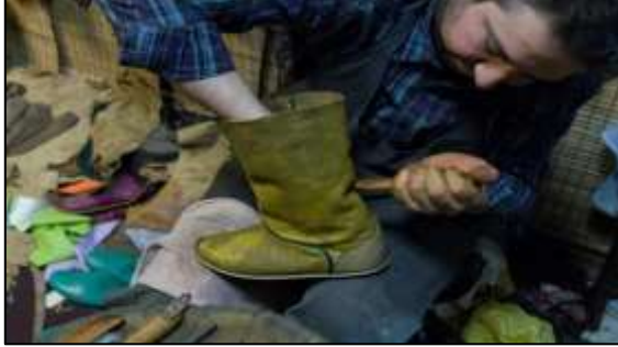
Resim 41: Edik'in bileğe denk gelen yerlerine hareket kıvrımı verilmesi.
