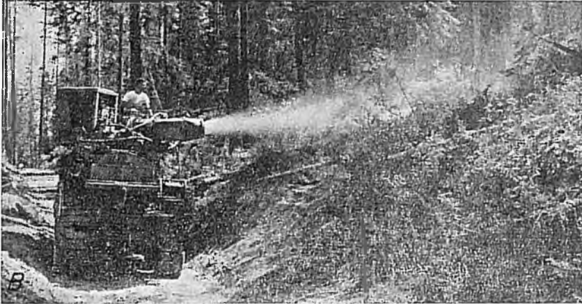
Resim 9.— Yol kenarındaki çalıhara 2,4,5-T püskürtülmesi. Uzak mesafelere püskürten yuvarlak ağızlı, motorlu pulverizatör.
