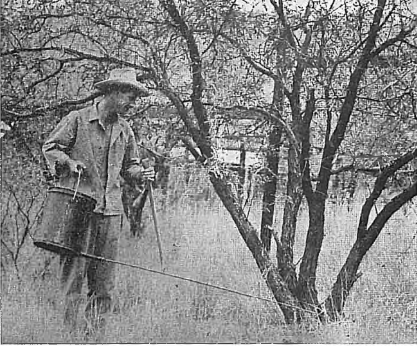
Resim 3.— Yağın çalılara tatbiki için basit bir cihaz. Bir kovaya yağa dayanıklı l stik hortum ile baėlı 1.80 m. uzunluėunda ve 1 sm. kalınlıėında bir borudan ibarettir.
