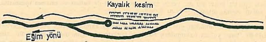
Resim 4.3. Her iki yamaçta da dere tabanına yakın arazinin dik kayalık olması halinde yol güzergâhının bu kısımda mecradan ayrılarak kayalığın yukarisından geçirilmesi ve aşağıda kalan orman parçasının bir kör makasla işletmeye açılması (HAFNER, 1964).
