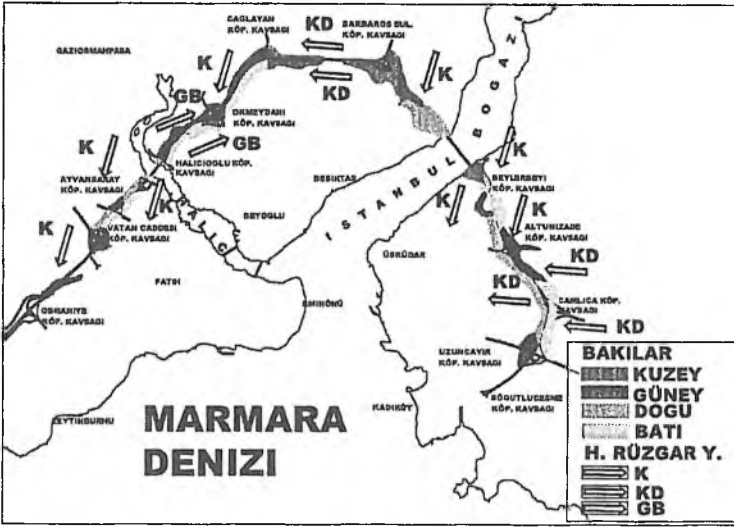
Şekil 2 : Araştırma alanı güzergah bakıları ve hakim rüzgar yönleri Figure 2 : Route of the experimental area and prevailing wind directions
