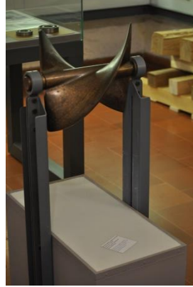
Fotoğraf 7: Giuseppe Ressel tarafından 1829 yılında Trieste limanında denediđi “ Civetta ” vapuruna ait pervane modeli
