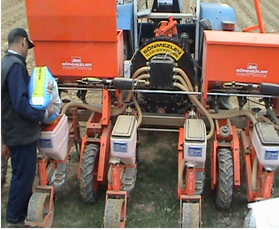
Şekil 2. Harita tabanlı uygulama ile kullanılan ve adapte edilmiş gübre depolu makina (Adana, 2007-2010)
