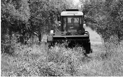
Şekil 1. Kendi yürür budama artığı parçalama makinası
