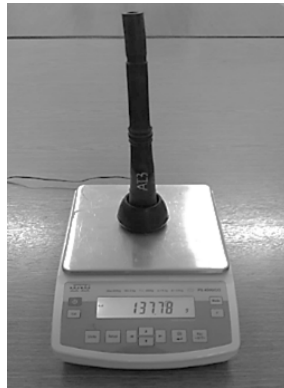
Şekil 6. Meme lastiğinin dijital terazide ağırlık ölçümü
