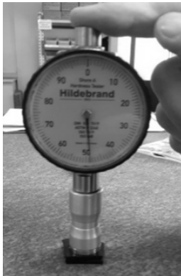
Şekil 5. Sertlik ölçme cihazının kauçuk parça üzerine uygulanışı
