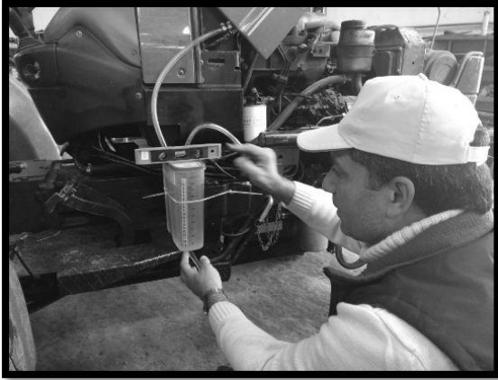
Şekil 3. Yakıtmytik77'de tüketilen yakıtın ölçülmesi
