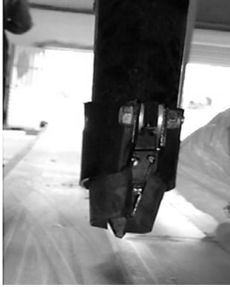
Şekil 12. Dikici ayak içerisine yerleştirilen metal plaka
