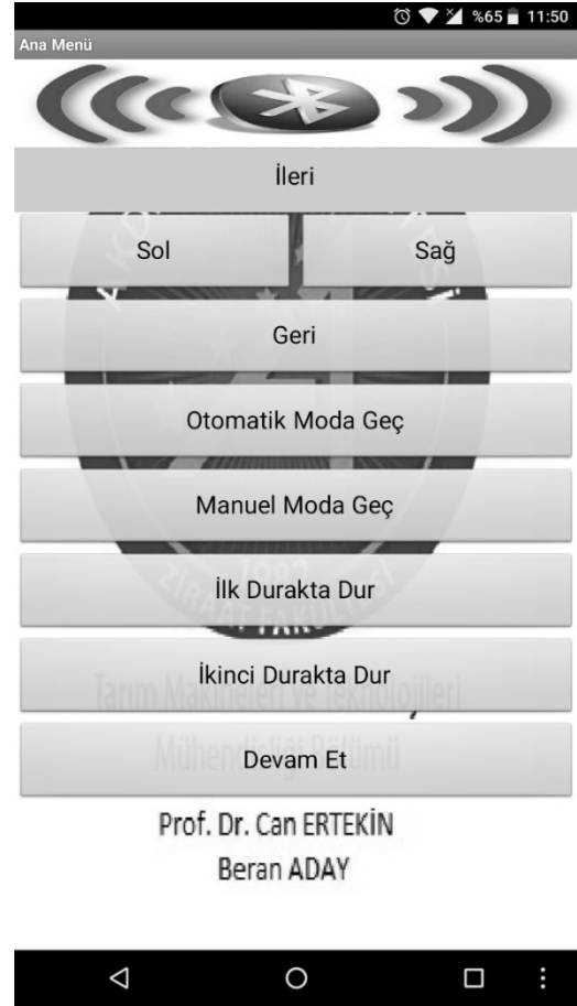
Şekil 4. Aracın kablosuz olarak yönetilmesi ve komut verilebilmesi için yazılan Android programının arayüzü
