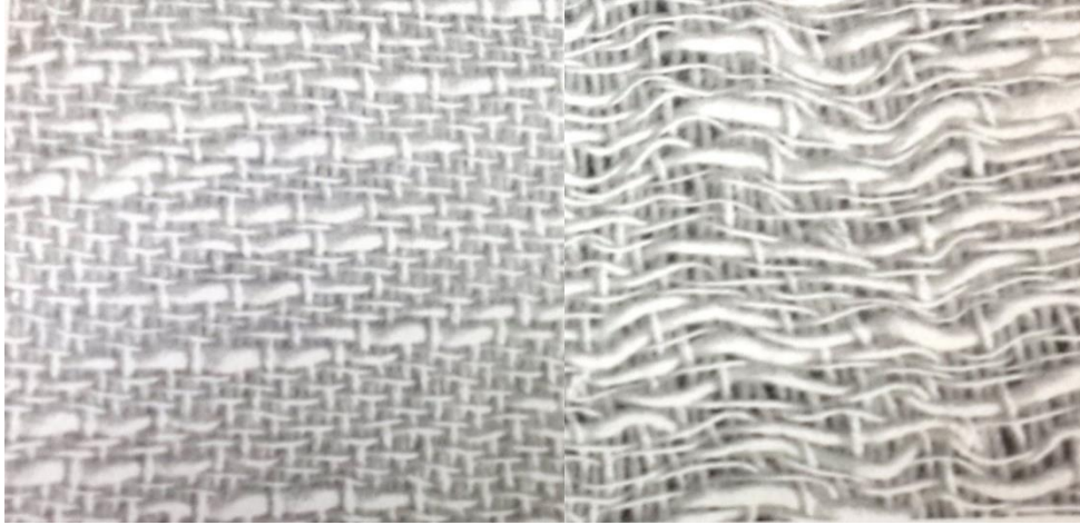
Fotoğraf 2.7. Solda 50/2 tarak numarası, sağda 50/1 numaralı tarak kullanılarak yapılan dokuma (Keskin 2012: 184)
