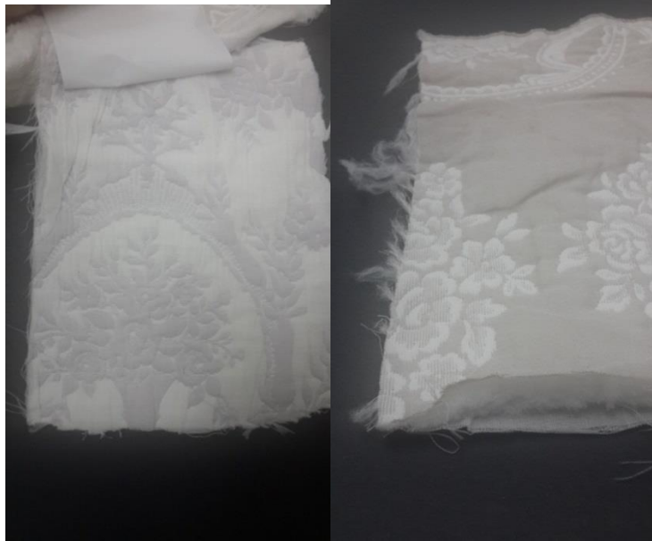
Fotoğraf 2.6. Dolgu ipliği kullanılarak dokunan kumaşın bitim işlem öncesi ve sonrası görünümü (Perka Tekstil Koleksiyonu, Fotoğraf: Gülşen Şefika Berber)
