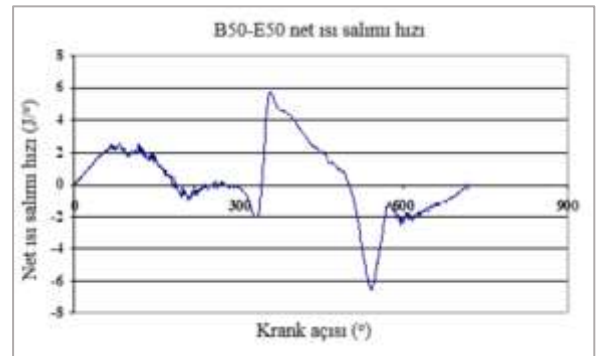
Şekil 12. B50-E50 karışım yakıtının net ısı salımı (FEBRİS)
