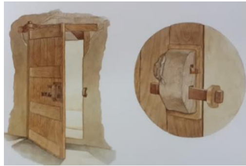
Görsel 2. Ahşap Kilit Sistemi rekonstrüksiyon çizim/Arslantepe Höyük
