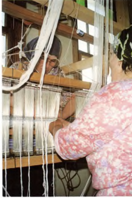
Resim 1. Çözüyü tezgâha geçirme (Feretiko dokumasında çözü tezgâha geçirme).
