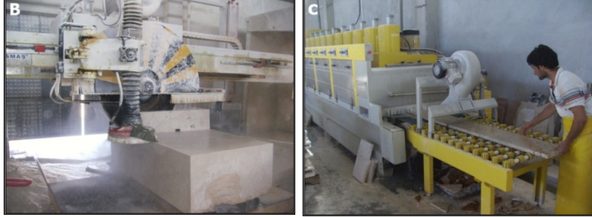
Fotoğraf 2. A- Hüseyin Avni Keleşoğlu Mermer San. Tic. Ltd. Şti.(HAKMER) Mermer Fabrikası'nın dıştan görünümü. B- Fabrikada makineyle mermer kesme işlemi. C- Mermer cilalama işlemi.
