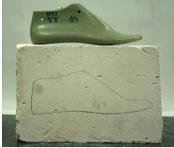
Resim- 3: Kalıp ve gazbeton üzerine çizilmiş profili.
