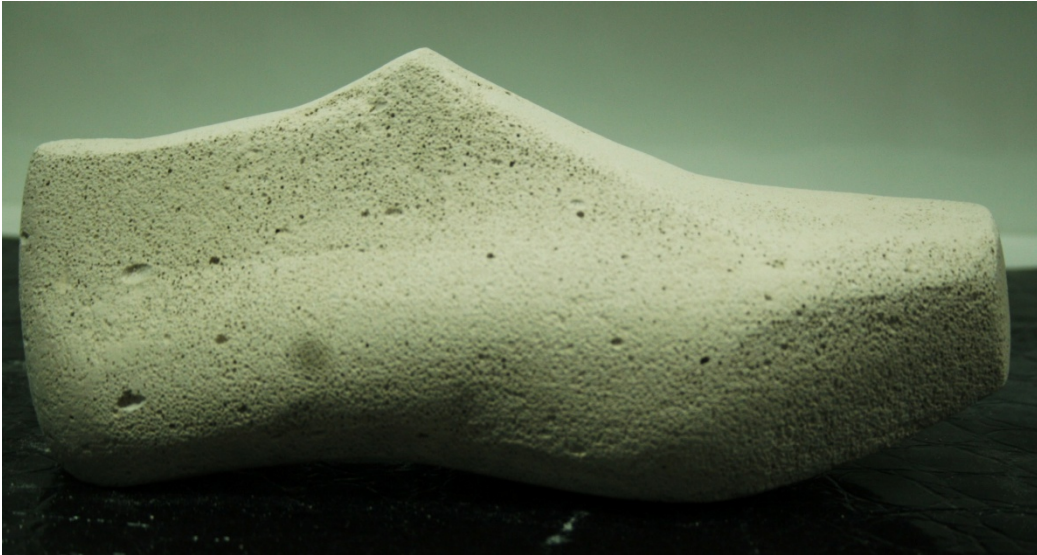
Resim- 6: Kabaca yontulmuş kalıp maketinin yandan görünüşü.
