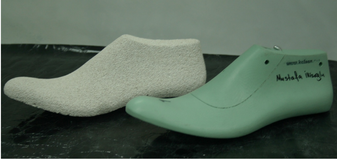
Resim- 8: Kalıp ve gazbetondan hazırlanmış maketi..
