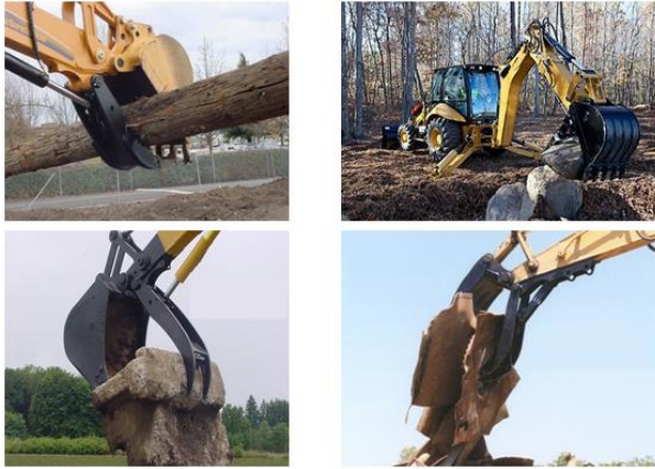
Şekil 4. Kazıcı kepçe ile çalışan çenelerin kullanım alanları
