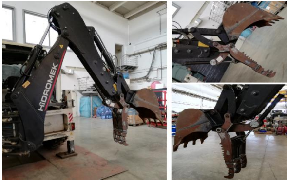
Şekil 26. Hidrolik çene ataşmanının makineye montajı
