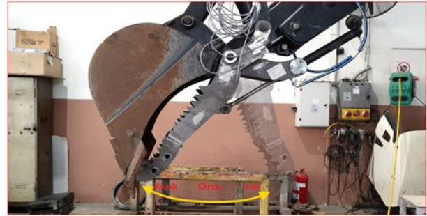
Şekil 28. Hidrolik çenenin açık, orta ve kapalı konumu
