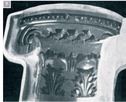
Şekil 8 ve 9. Bezemeli dolgu parçalı ahşap korniş kalıbı kesiti (sol; Childe, 1961; s.163) ve Kompozit düzende pilastr başlığı için alçı kalıp (sağ; Lade ve Winkler, 1955; s. 229)
