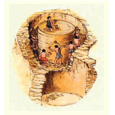
Şekil 3. Antik sütunların yerinde çıkarılması (Bingöl, 2004; Atlas Dergisi, Nisan 1998)
