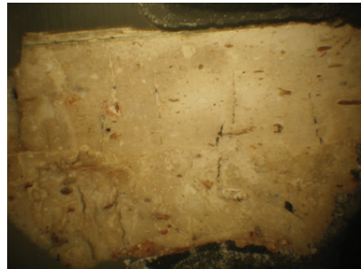
----- 10 mm----- (Tek Nikol, Stereo Mikroskop) Resim 57. Örnek 22'nin genel dokusu.
