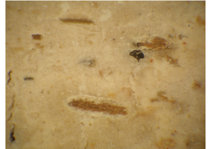
-----2 mm----- (Tek Nikol, Stereo Mikroskop) Resim 58. Örnek 22'den detay. Kıtık parçaları, tuğla tozları ve siyah cüruf parçacığı.
