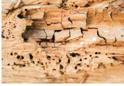
Şekil 3. Ahşapta esmer çürüklük mantarının yapmış olduğu bozunma ve odun delici böceklerin yapmış olduğu tahribat (Turner, 2008)
