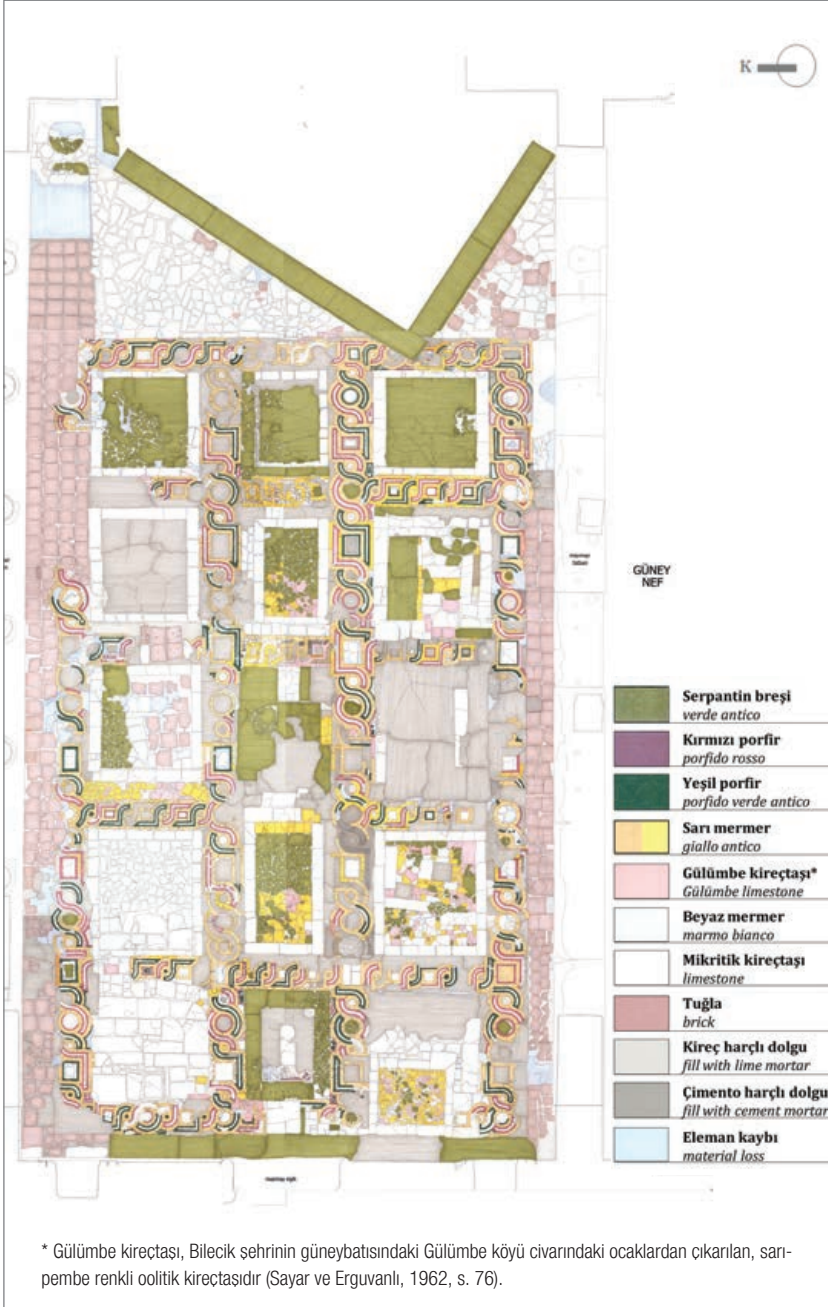
Şekil 32. Naos döşeme planı: Malzeme tespiti
