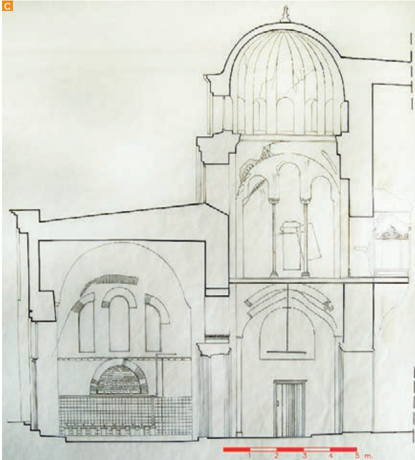
Şekil 6. Zeyrek Camii, hünkâr mahfili rölövesi (2003), A. plan, restitüsyon, B. plan, rölöve, C. doğu-batı doğrultulu kuzeye bakan kesit (3-3), D. kuzey-güney doğrultulu batıya bakan kesit (1-1)
