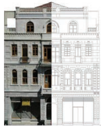
Şekil 13. Düzeltilmiş görüntü mozağı ile iki boyutlu çizimin karşılaştırılması
