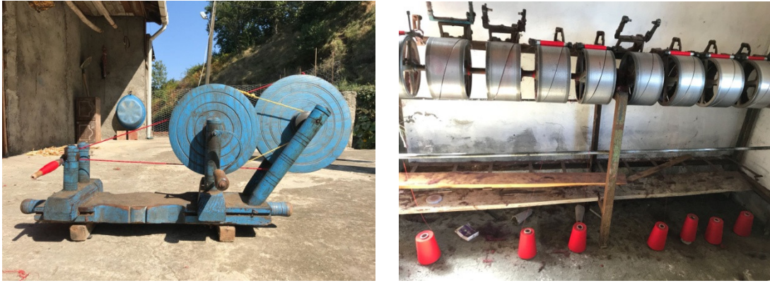
Resim 9. Eskiden Kullanılan Manuel ve Günümüzde Kullanılan Otomatik İplik Sarma Makinesi (KK6)
