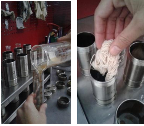
Şekil 2. Çözelti ve ipliklerin test tüplerine aktarımı (Aydın, 2018)
