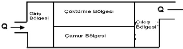
Şekil 2 Çöktürme havuzunun fonksiyonel bölgeleri (3).
