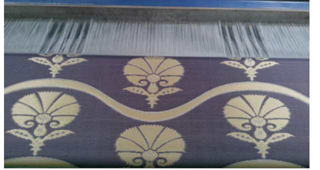
Şekil 7: Jakar Makinesinde Dokunan Mor Renkli Kumaş
