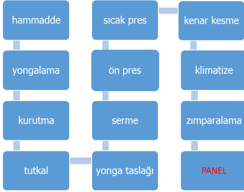
Şekil 2. Levha üretiminde genel iş akışı
