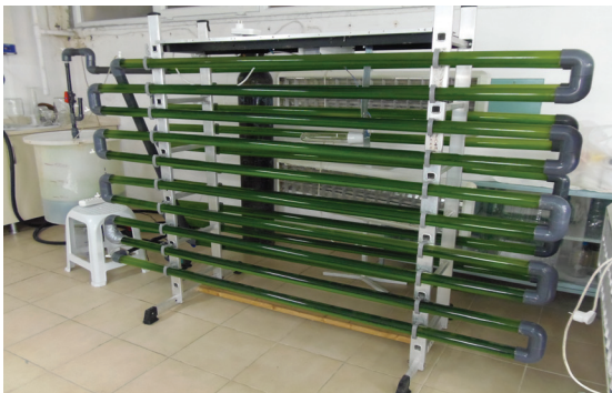
Şekil 1- Tübüler fotobiyoreaktörün genel görünümü
