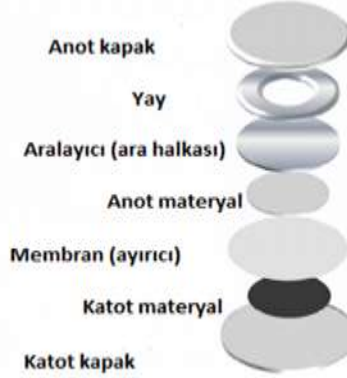
Şekil 2. Pil bileşenleri ve pil basımında izlenen sıra.
