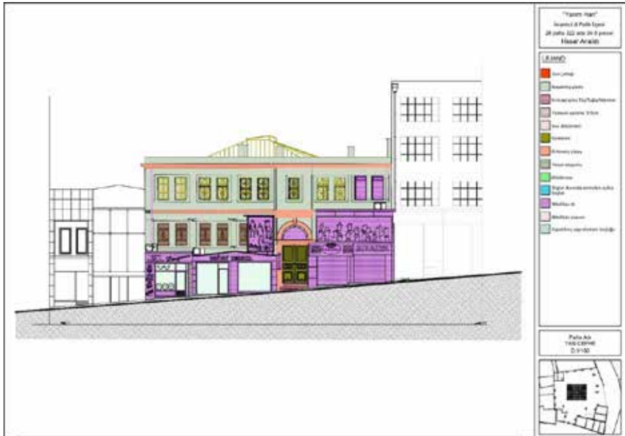
Şekil 3. Yarım Han Bezciler Sokak Cephesi Hasar Analizi (Öztekin, 2016).
