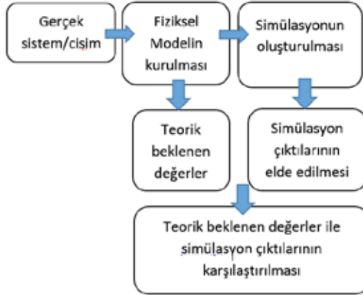
Şekil 2.1. Gerçek bir sistem ya da cismin fiziğe dayalı ses simülasyonu oluşturulurken genel olarak izlenen adımlar.
