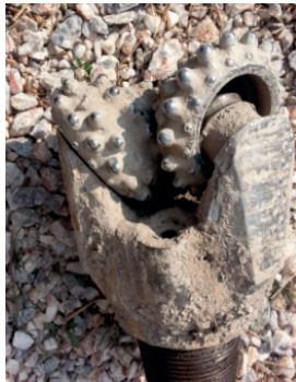
Şekil 10. GLI'de üç konili matkapların aşınma tipi
