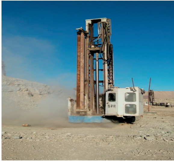
Şekil 9. Tunçbilek Kömür Havzası'nda kullanılan DM50XL900 model delicilerden biri
