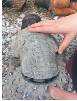
Şekil 10. GLI'de üç konili matkapların aşınma tipi
