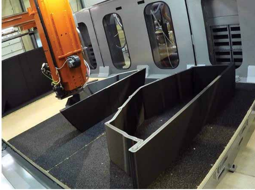
Şekil 6. 3B basılan kompozit tekne kalıbı (JEC Group, 2017)
