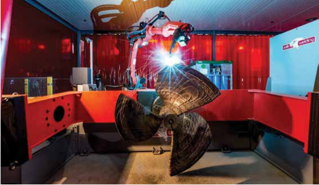
Şekil 8. WAAMPeller (Damen, n.d.)
