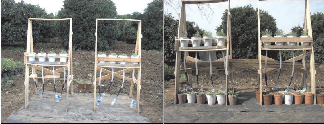
Şekil 1. Adi fiğ kök salgılarının toplanması için kullanılan düzenek Figure 1. The assembly to collect of common vetch root exudate
